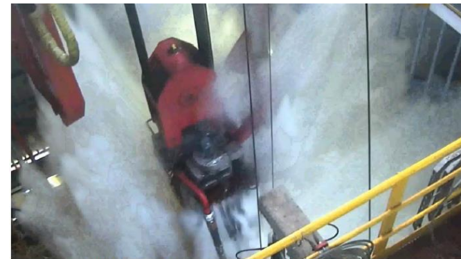
Figur 15 Utstrømning av gass og væske fra fingerbord nivå (kilde: Songa Offshore)
